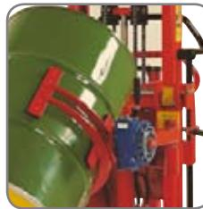
O sistema de mudança rápida permite rápida e facilmente substituir o volteador de tambores por outro acessório.
