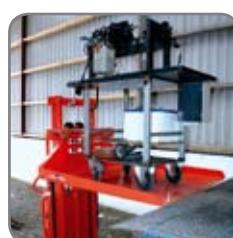
Logiflex com plataforma a transportar uma máquina com rodas.
