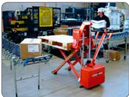
Altura da foto célula ajustável. Em porta paletes tesoura: entre 490 e 970 mm; em stackers: entre 550 e 920 mm.
