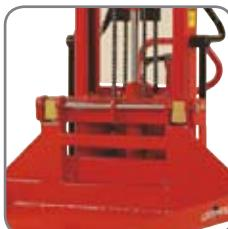
Sistema de engate rápido para fácil troca de acessório aplicado na máquina.
