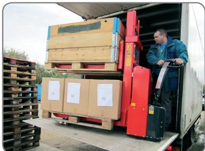
Peso próprio reduzido permite uma utilização mais eficaz da capacidade de carga da rampa do camião.
