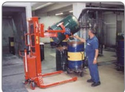
O volteador manual é aplicável em toda a gama Logiflex, o volteador eléctrico só pode ser aplicado nos modelos eléctricos de Logiflex.
