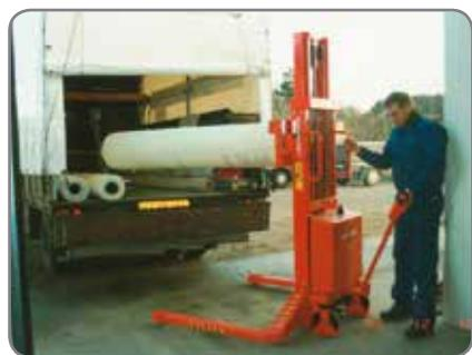
Um Logiflex com bastidor ajustável trata rolos dum camião.
