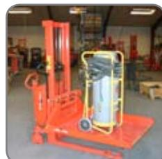
Logiflex com plataforma aqui usado para elevar e transportar aspirador.
