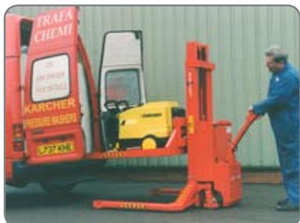
Logiflex com plataforma aqui usado para elevar e transportar máquina de lavar de alta pressão.
