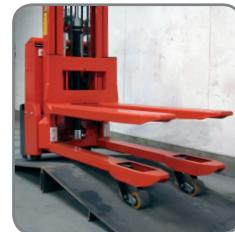
Elevada altura livre facilita a passagem por esquinas e a utilização em solos desnivelados.
